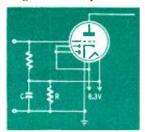
Fig. 8—Internal diodes rectify the bias.
